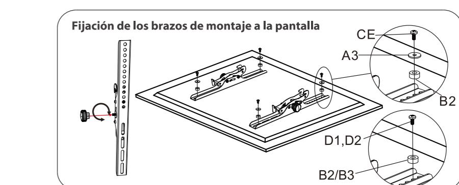
4. Deberá utilizar un espaciador si el panel posterior de la pantalla tiene forma irregular o punto de montaje embutido para compensar la diferencia de profundidad.
